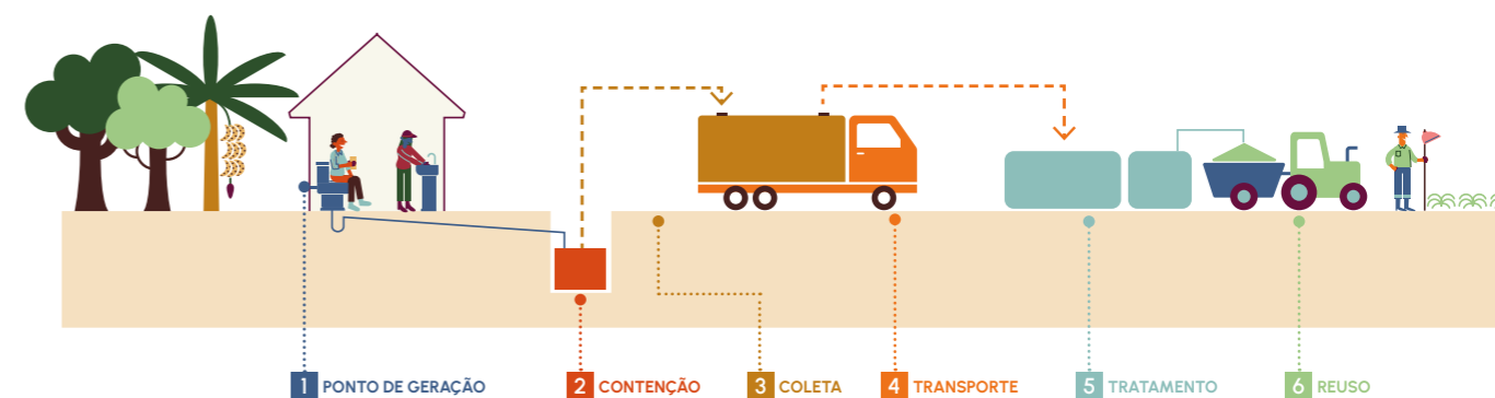
Figura 5: Possível arranjo das etapas em sistema descentralizado
